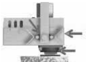
Rysunek 7 – Punkty smarowania łożyska szczotki © Agricow srl
