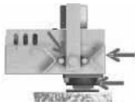
Figure 7 - Points de lubrification du palier de brosse © Agricow srl
