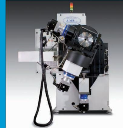
Über eine Schnittstelle können Biegeprogramme direkt aus den CAD-Daten erzeugt werden. Biegeteile können mittels eines Messarmes vermessen werden und dann korrigiert das Messprogramm anhand der Solldaten das Biegeprogramm.
