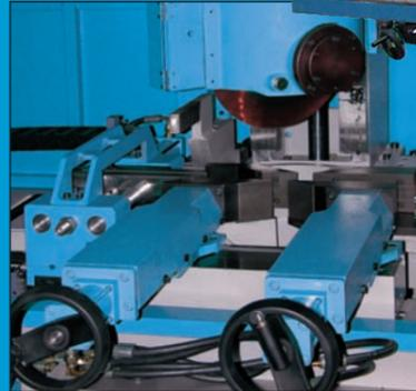
Auf Wunsch erhältlich: Sägekopf ist automatisch im Ablauf auf verschiedene Gehrungen schwenkbar. Parallelogramme, Trapeze etc. sind so in einer Aufspannung herstellbar
