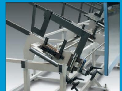
Schrämagazin mit zentraler Verstellung auf unterschiedliche Rohrdurchmesser
