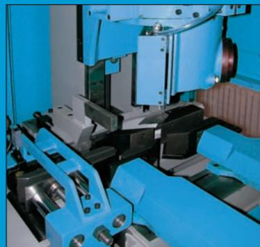
Stabiles Sägeaggregat mit max. Sägeblatt Ø 370 mm für ruhigen, vibrationsarmen Lauf auf Flachführungen. Unabhängig voneinander einstellbare Spannbacken und Andruckrollen. Abnutzungsanzeige für das Sägeblatt. Vorschub über Andruckrollen gegen Festanschlag.
