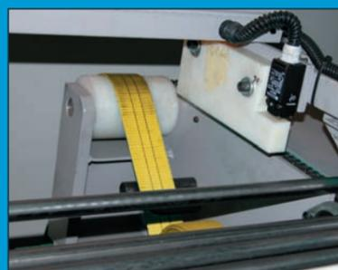
Gurtlademagazin mit einer Kapazität von 4000 kg.
