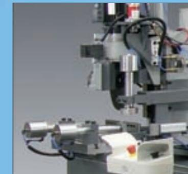
Die Spannung des Profils erfolgt über pneumatische, horizontale Spannzyylinder. Ein oder mehrere vertikale Spannzyylinder sind als Option erhältlich. Das komplette Spannsystem kann auf Wunsch auch als hydraulische Spannung ausgeführt werden.
