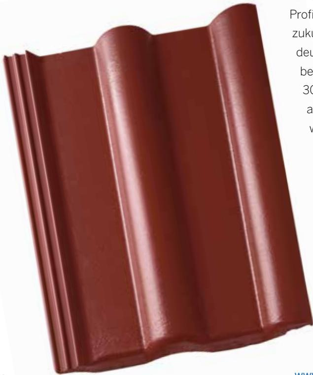
Seit mehr als einem halben Jahrhundert prägt das klassische Profil der Frankfurter Pfanne die deutsche Dachlandschaft. Die zukunftsweisende Protegon-Technologie zeichnet sich durch eine deutlich glattere Schnittkante aus. Die in die Oberfläche eingearbeiteten Infrarotlicht reflektierenden Pigmente leisten bis zu 300 Prozent mehr Wärmereflexion. Somit kann die Temperatur auf der Unterseite des Dachsteins um bis zu 10°C reduziert werden.
