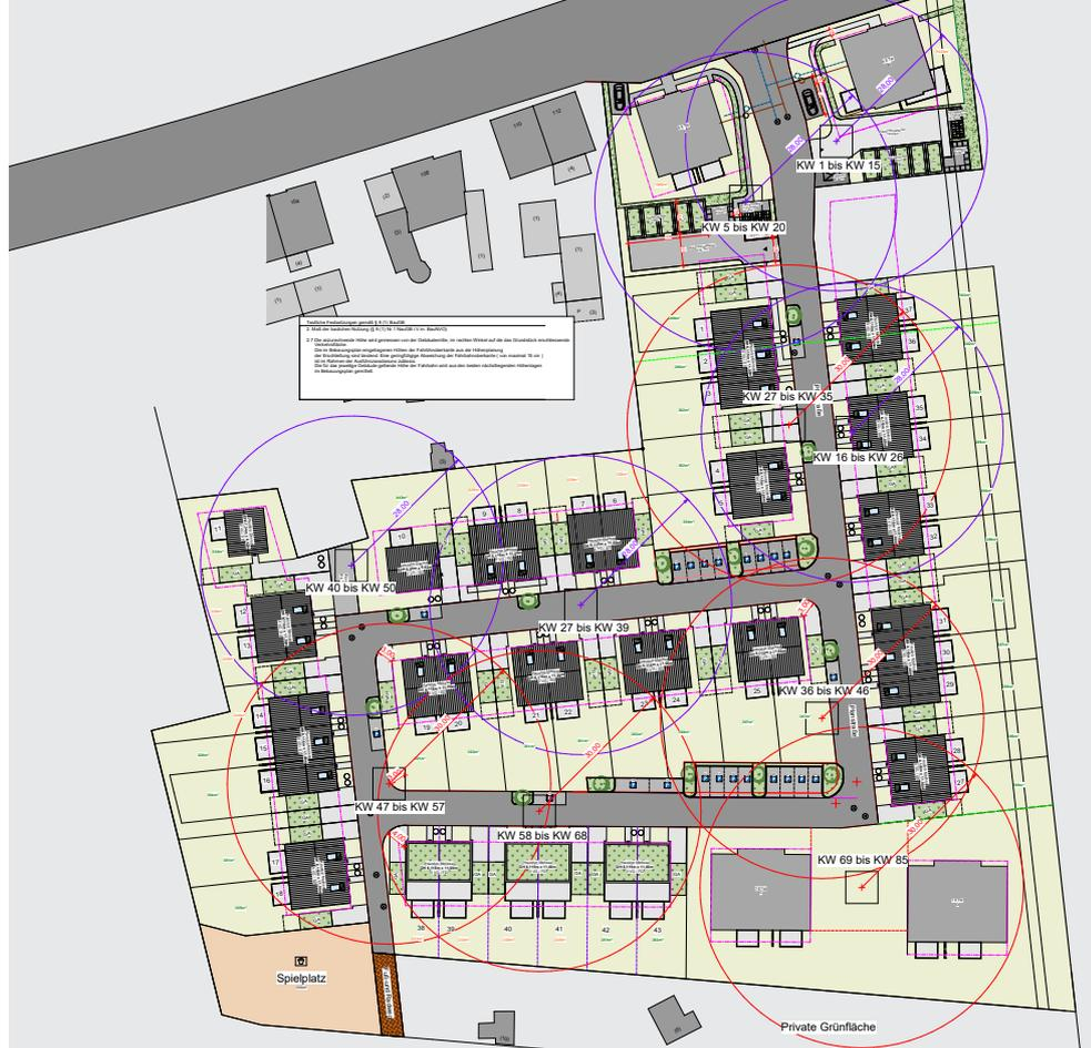
▲ Zwei Krane mit Auslegerlängen zwischen 26 und 32 Meter sollen über das gesamte Baufeld schwenken.
