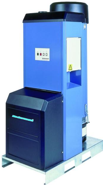
E-PAK 500, zur Absaugung direkt an Schweiß-, Schleif- und Schneidwerkzeugen oder kleinen stationären Schleifmaschinen. Stationäre oder halbbewegliche Installation. Vakuumeinheit mit schallgedämpften direktgetriebenem Seitenkanalverdichter wird als eine Einheit mit Filtersystem, Steuereinheit mit Bedientableau und integriertem 24-VTrafo auf einen Stahlprofilrahmen montiert.
